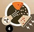
Mit Schwerkraft, Elektro statik und Druckluftströmen werden Kunststoffe und Aluminium abgetrennt.
