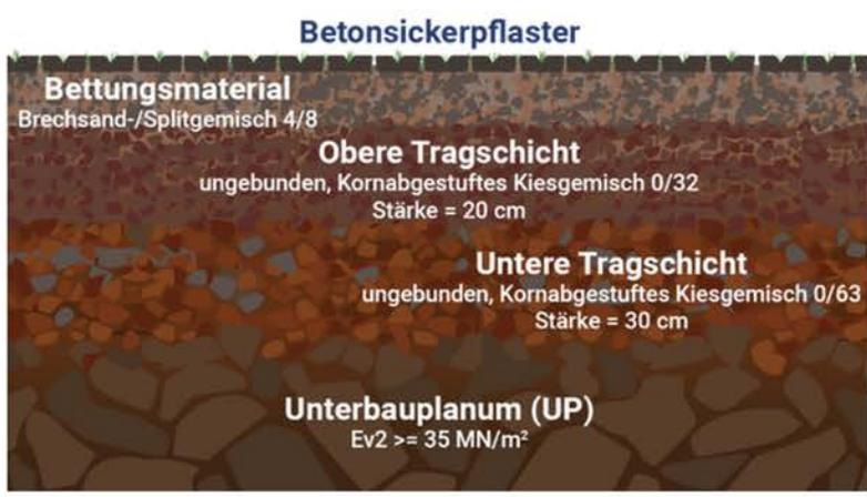
**Ökopflaster** aus Beton, das mit einer breiten **Drainfuge** verlegt wird. Die Drainfuge zeichnet sich durch eine besonders hohe und lang anhaltende Sickerfähigkeit aus. So werden Kanäle und **Kläranlagen entlastet**, der Grundwasserhaushalt bleibt ungestört.
