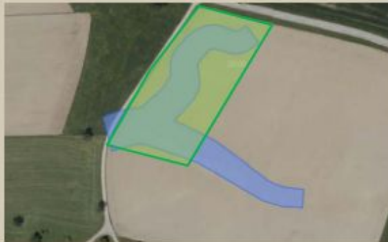
Großzügige Begrünung, die einen Teil des ausgewiesenen Eintragspfades beinhaltet
